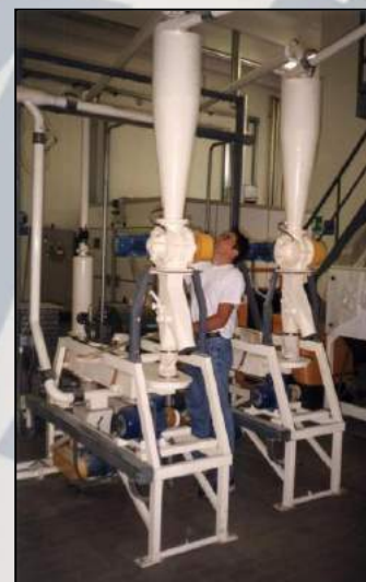
Ciclone di decantazione (CDP) Decantation cyclones.
