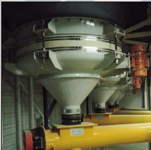
Estrattore a vibrazione Flat bottom extractor
