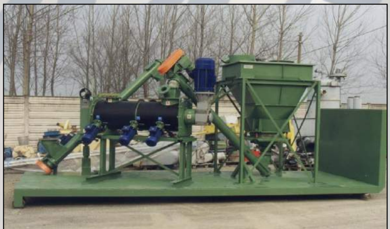
Gruppo di inertizzazione su scarrabile. Inertial group on system not suitable for vehicles.
