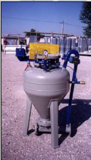
Propulsore pneumatico. Dense phase conveying system.
