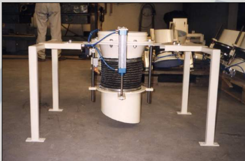
Caricatore telescopico (TT). Telescopic loader (TT).
