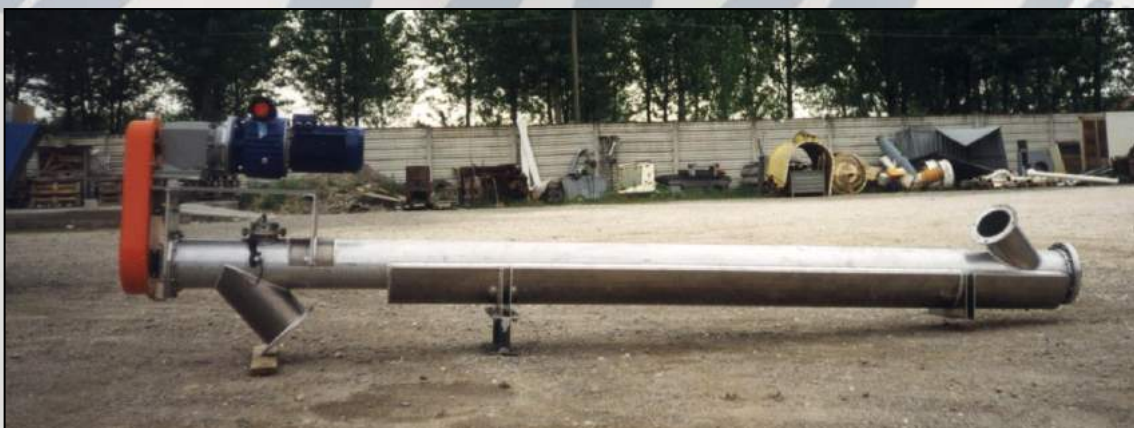
Coclea con raffreddamento (CLT speciale) Screw with cooling (CLT - special conveyor)
