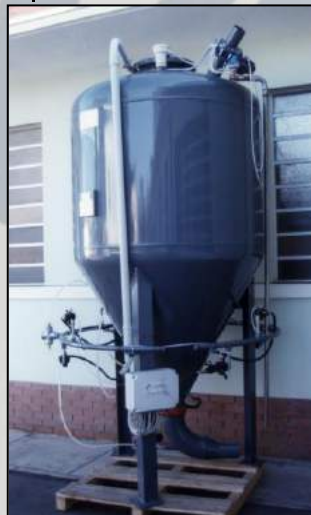
Propulsore pneumatico. Dense phase conveying system.
