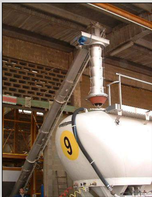
Caricatore telescopico (TT). Telescopic loader (TT).
