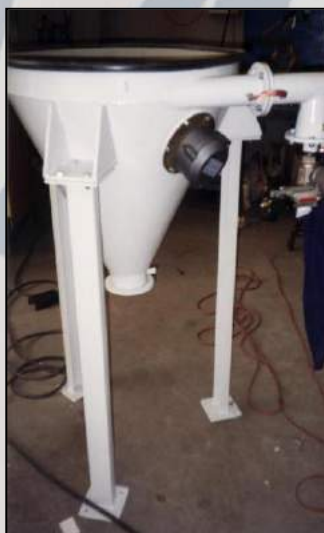
Ciclone sotto filtro. Cyclones with filter.
