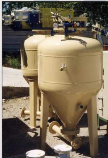
Propulsore pneumatico. Dense phase conveying system.
