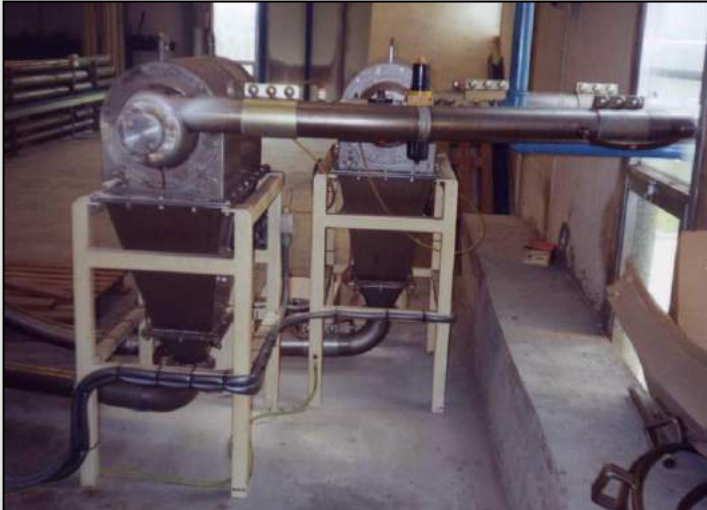
Pneumoseccio. Double centrifugal sieve.
