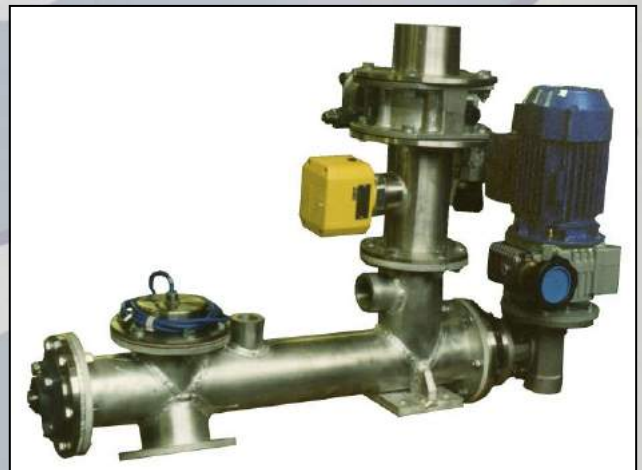
Microdosatore in Al per prodotti infiammabili. Al micro batching plant for inflammable products.
