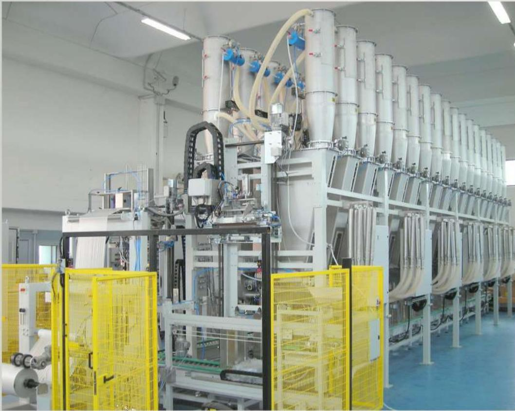
Un ruolo molto importante, per le caratteristiche finali della miscela, viene svolto dai microcomponenti, quali additivi, acceleranti e vulcanizzanti, che vengono aggiunti in una o più fasi durante la miscelazione. In funzione del tipo di produzione, i componenti possono essere da poche unità a diverse decine. Questa attività viene spesso realizzata manualmente da un operatore con elevato rischio di errori e scarsa ripetibilità delle ricette.
