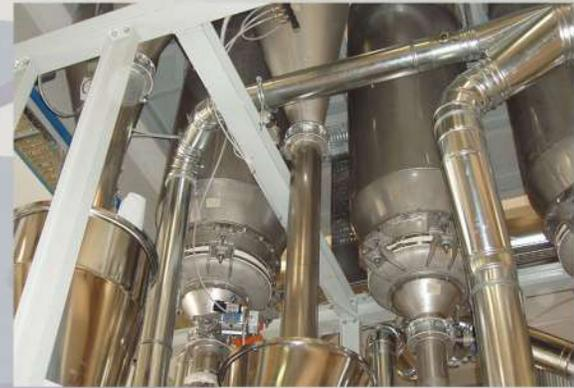
La tecnologia in fase densa, grazie ad una velocità ancora più ridotta, è idonea per preservare l'integrità di prodotti particolarmente fragili.
