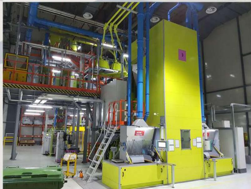
La bassa velocità di trasporto consente di mantenere inalterate le proprietà di prodotti chimici primari, secondari e fine chemicals ossia prodotti chimici ad alto contenuto tecnologico. Le nostre soluzioni si avvalgono della tecnologia di trasporto pneumatico in fase diluita e della tecnologia in fase densa per preservare l'integrità del materiale. La scelta del metodo di trasporto viene effettuata in base alla tipologia del prodotto e alle esigenze del cliente.
